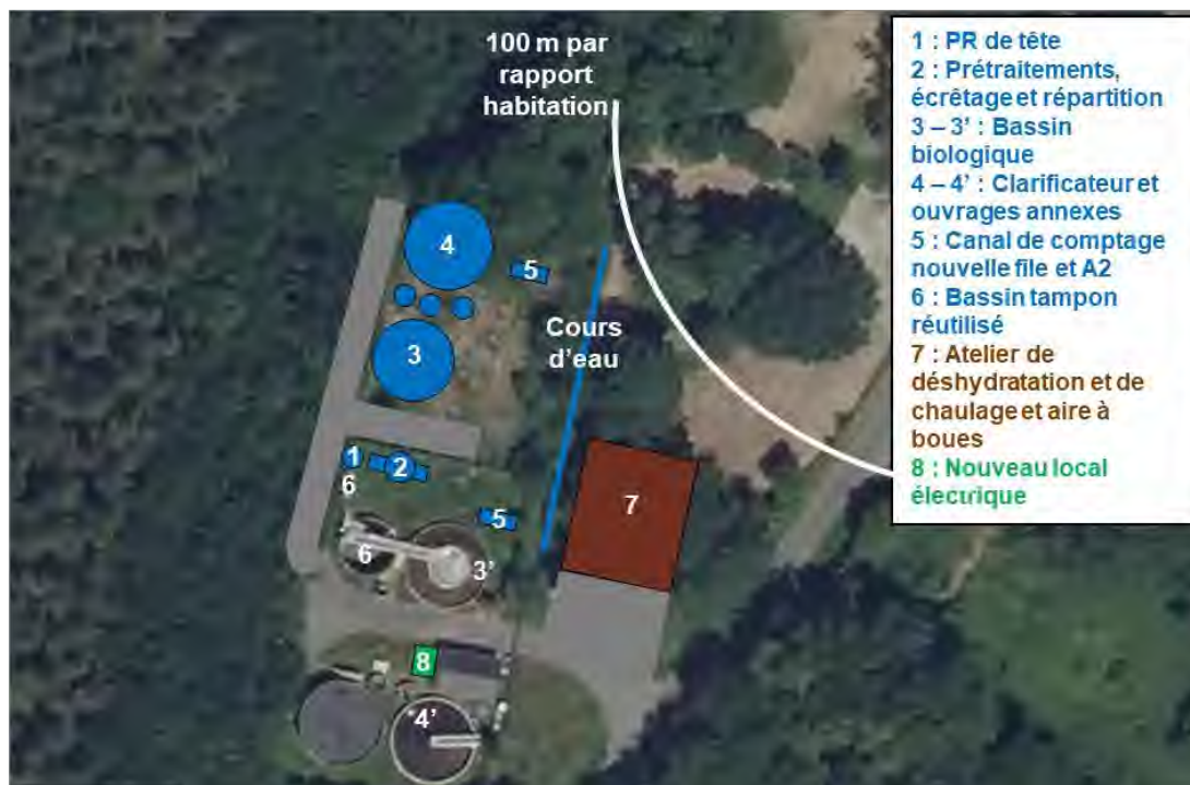
Figure 39 : Implantation des ouvrages de la future station - Solution boues extensives : déshydratation et stockage sous aire couverte
